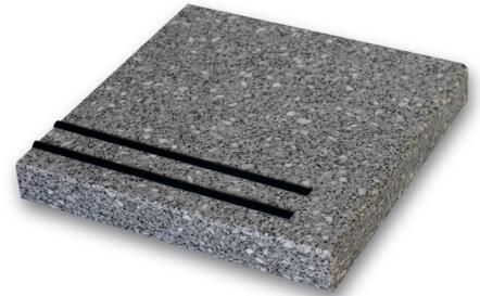
**Edelstahlprofile** werden als ein- oder zweireihige Profile mit einer Breite 4 mm und mit 2 mm Überstand in die Trittstufen eingebaut. Der Einbau kann durchlaufend oder vor den Stufenköpfen endend erfolgen.
